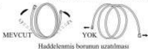
Haddelenmiş borunun uzatılması
